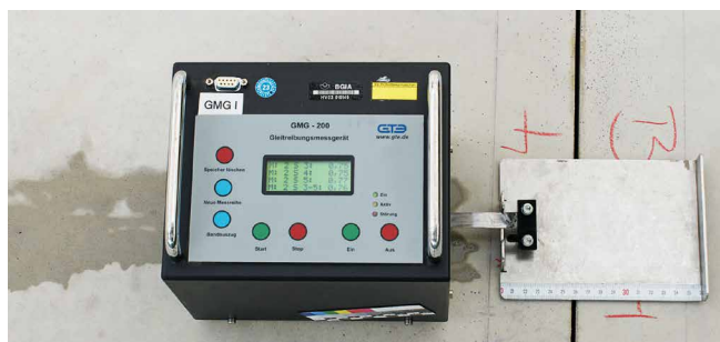
Abb. 3: Messung des Gleitreibungskoeffizienten mit dem GMG-Gerät
