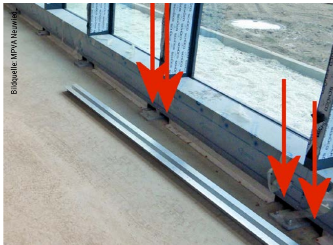
Abbildung 3: L-Winkel als Variante, um den Rüttelboden sauber abstellen zu können
