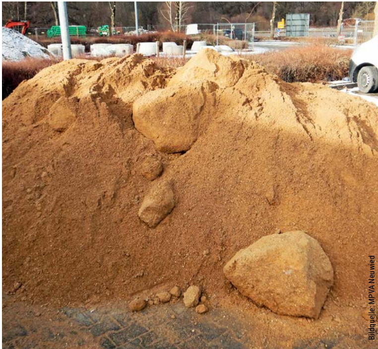
Auch die Lagerung des Sands unter freiem Himmel kann kritisch sein.
