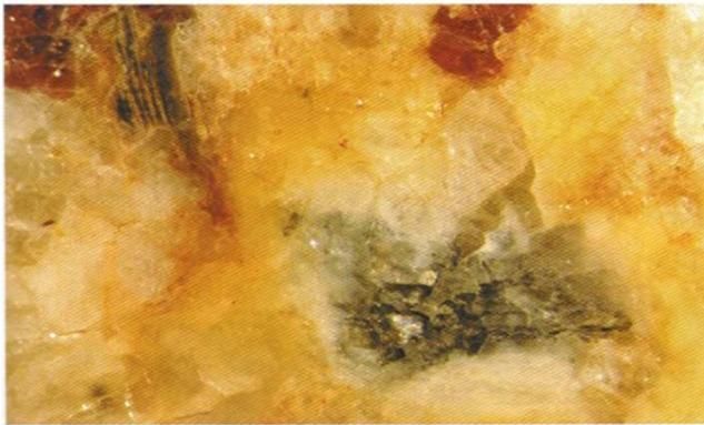
Stereomikroskopische Aufnahme eines granulitischen Gesteins mit Rostverfärbungen, die auf Pyrit zurückzuführen sind. Bildbreite ca. 1 cm.
