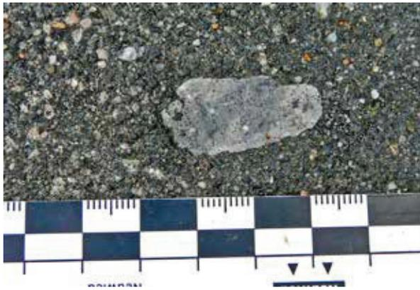
Abb. 4a: Gesteinskörner mit einem dichten Gefüge und einem hohen Frost-Tausalz-Widerstand ...
