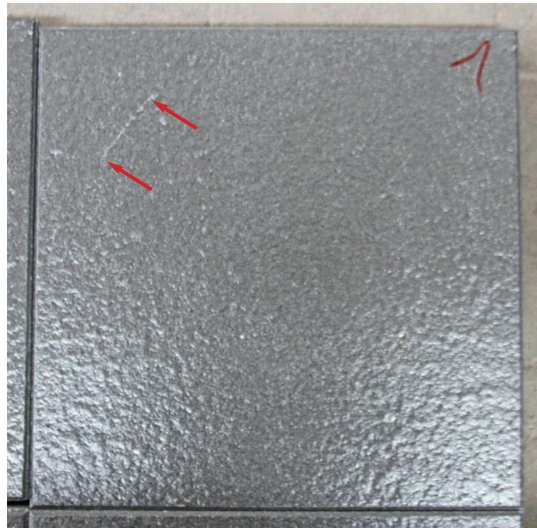
Abb. 1: Reklamation aufgrund geradlinig verlaufender Kratzspuren
